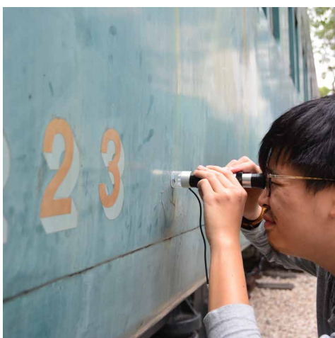
文物修復人員利用手提顯微鏡檢查火車車廂的面漆。
